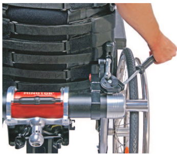
2 moteurs entraînent directement les roues. Il est possible de débrayer et de rouler librement
