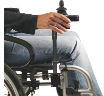
Mettre en place la commande correspondante sur la glissière installée sur votre fauteuil
