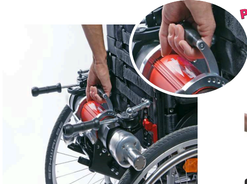
Poser la motorisation sur les crochets rouges du fauteuil
